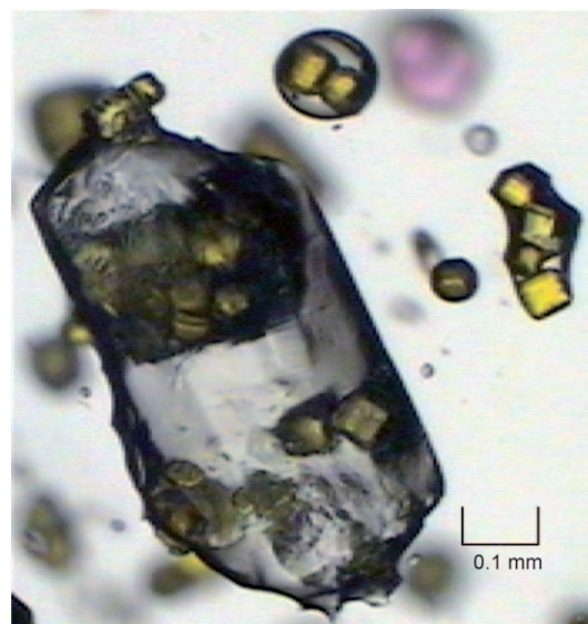
Abbildung 1. Mikroskopaufnahme der Kristallumwandlung (farblos: reaktives Intermediat, gelb: Benzylolithiumverbindung).
